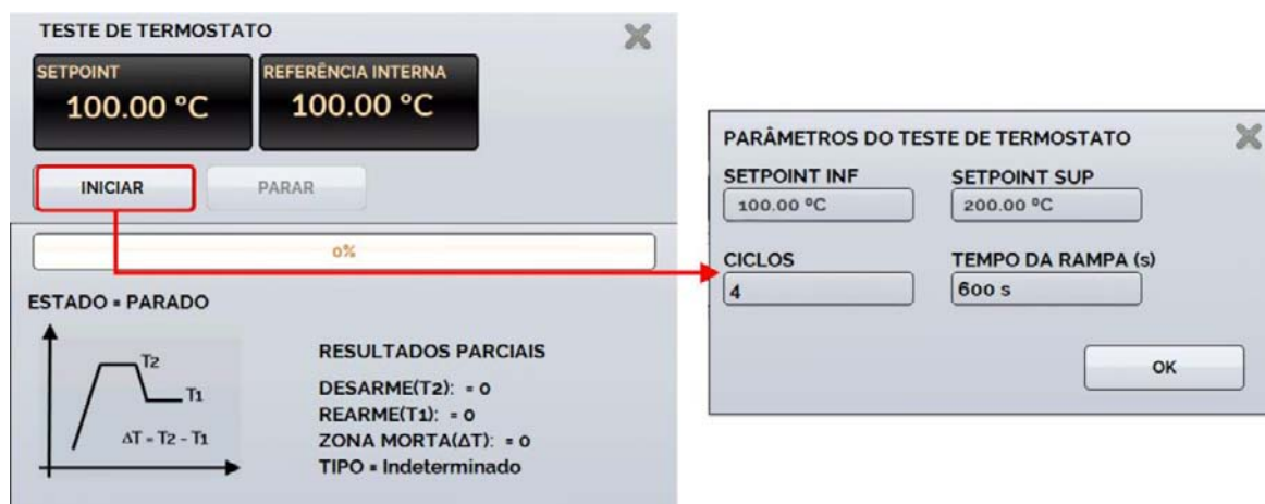
Fig. 14 - Parâmetros de teste automático de termostato
