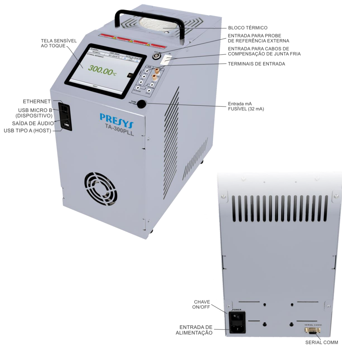
Fig. 01 - Identificação das Partes
