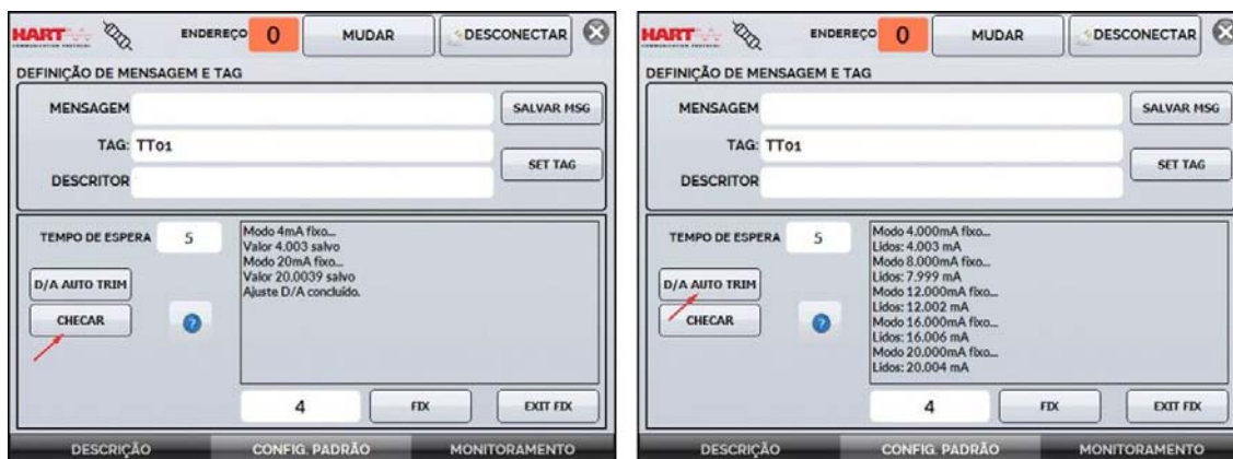
Fig. 25 - Checando / Ajustando a saída mA HART® do transmissor
