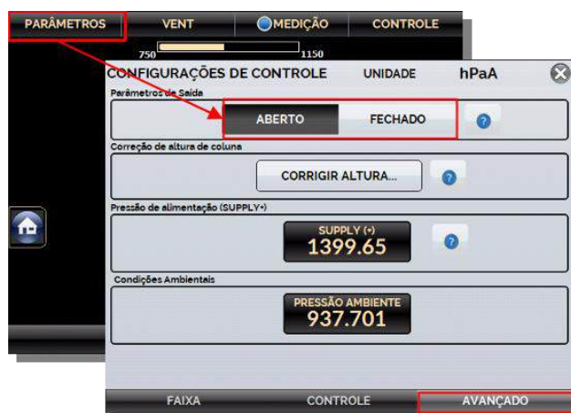
Fig. 14 - Estado da Válvula de Isolação de Saída
