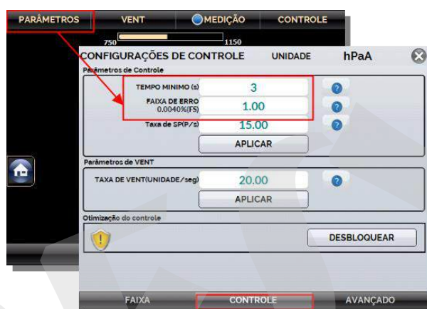
Fig. 15 - Configuração de Estabilização
