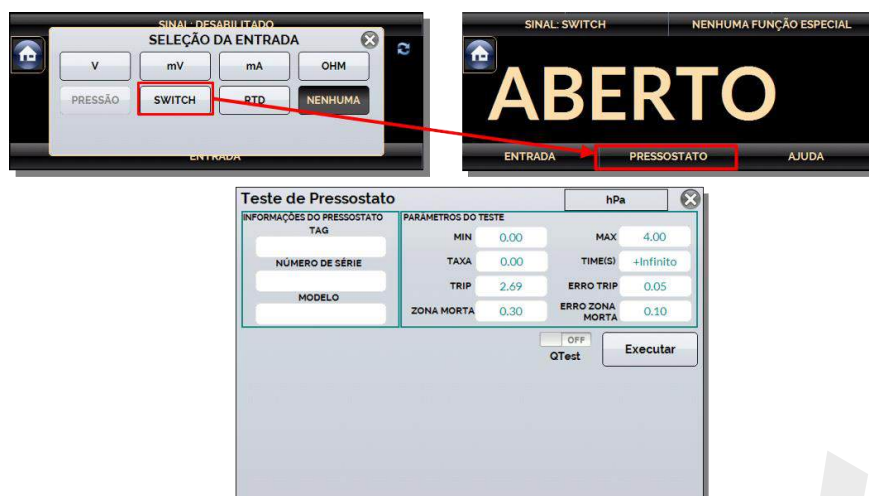
Fig. 41 - Teste de Pressostato
