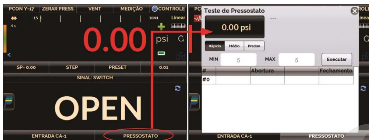
Fig. 48 - Teste de Pressostato
