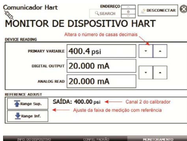
Fig. 60 - Ajuste da faixa de medição do transmissor HART® com referência
