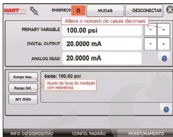
Fig. 67 - Ajuste da faixa de medição do transmissor HART® com referência
