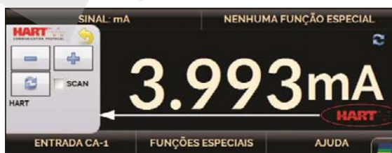
Fig. 66 - Ajuste rápido HART® com Referência
