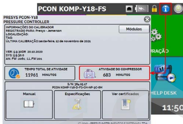
Fig. 117 - Manutenção Preventiva do Compressor
