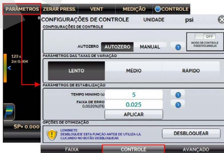
Fig. 20 - Configuração de Estabilização
