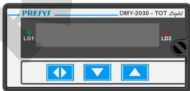
Fig. 1 - Painel frontal do Indicador Integrador e Totalizador DMY-2030-TOT Light
