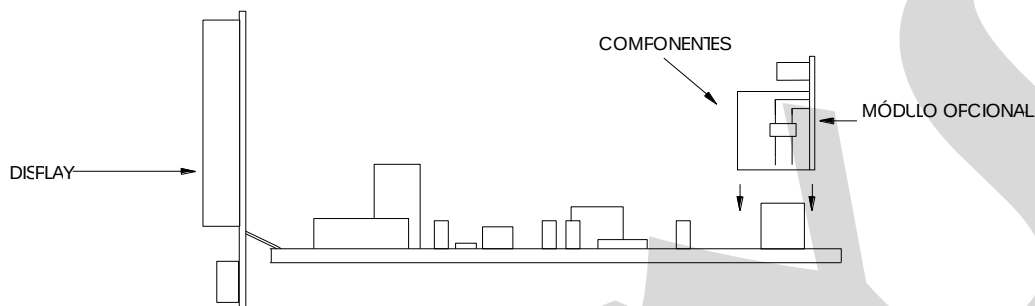
Fig. 24 - Instalação dos módulos opcionais
