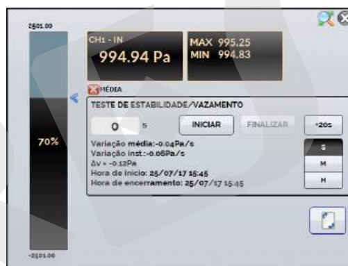
Fig. 50 - Teste de Vazamento/Estabilidade - Resultados
