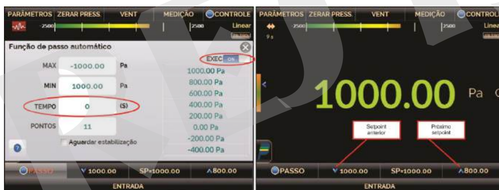
Fig. 24 - Função PASSO (Programa de passo manual)
