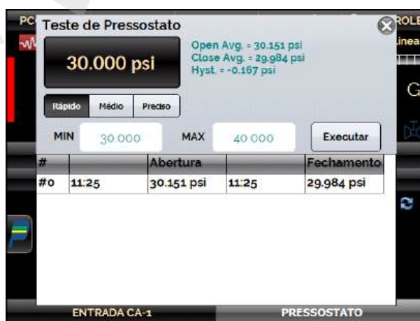
Fig. 46 - Resultados do Teste de Pressostato
