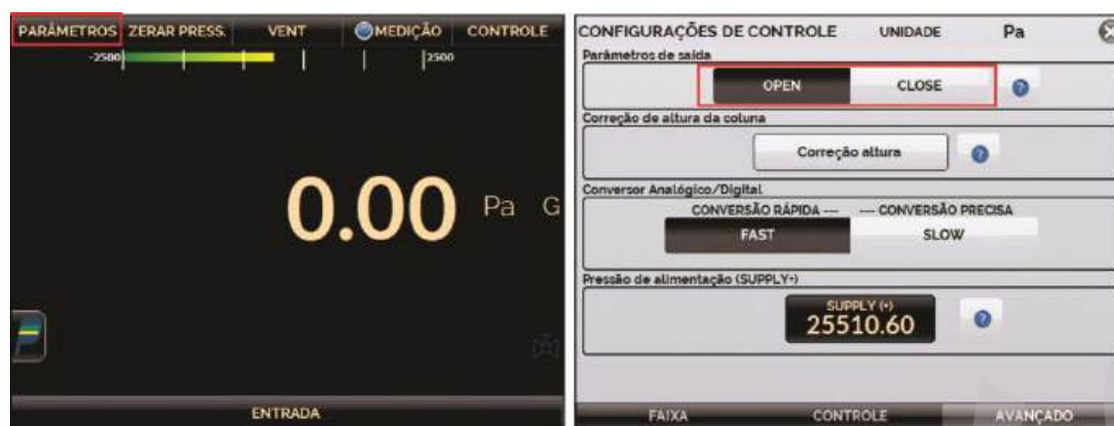
Fig. 11 - Estado da Válvula de Isolação de Saída
