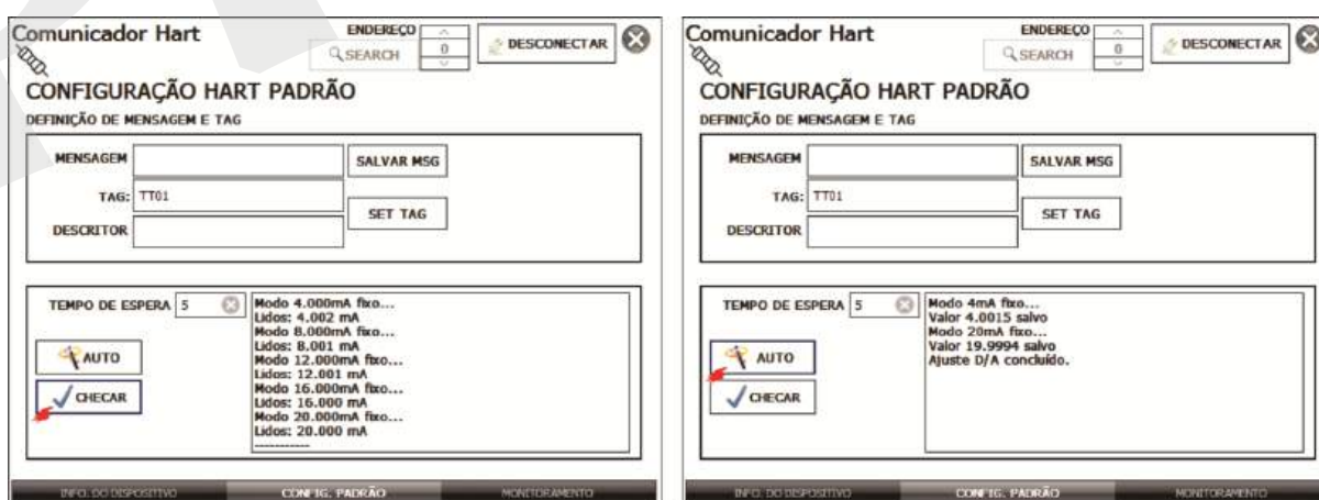
Fig. 58 - Verificação / Ajuste da saída mA do transmissor HART®
