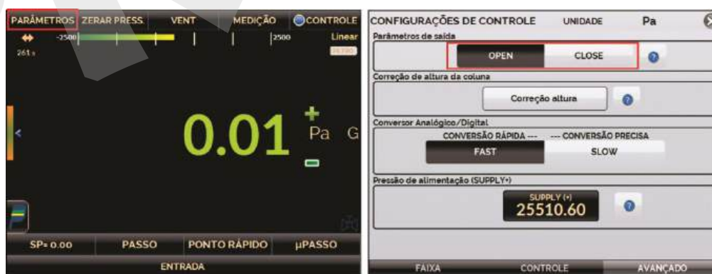
Fig. 28 - Estado da Válvula de Isolação de Saída
