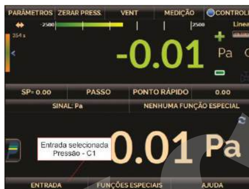
Fig. 47 - Teste de Vazamento, Selecione o modo MEDICÃO e a ENTRADA
