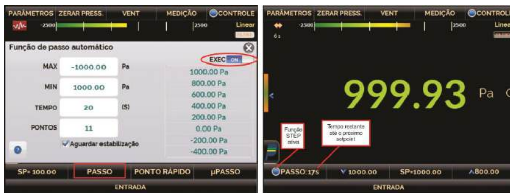
Fig. 23 - Função PASSO (Programa de STEP automático)
