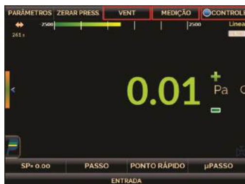
Fig. 06 - Módulo de Controle de Pressão - Modos de Operação
