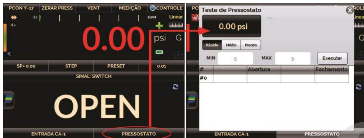
Fig. 45 - Teste de Pressostato
