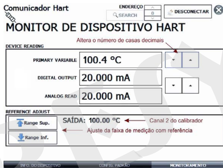
Fig. 22 - Ajuste da faixa de medição do transmissor HART® com referência
