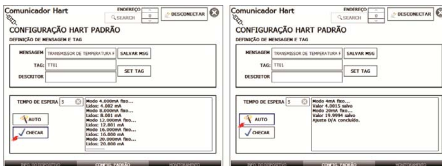
Fig. 23 – Verificação / Ajuste da saída mA do transmissor HART®
