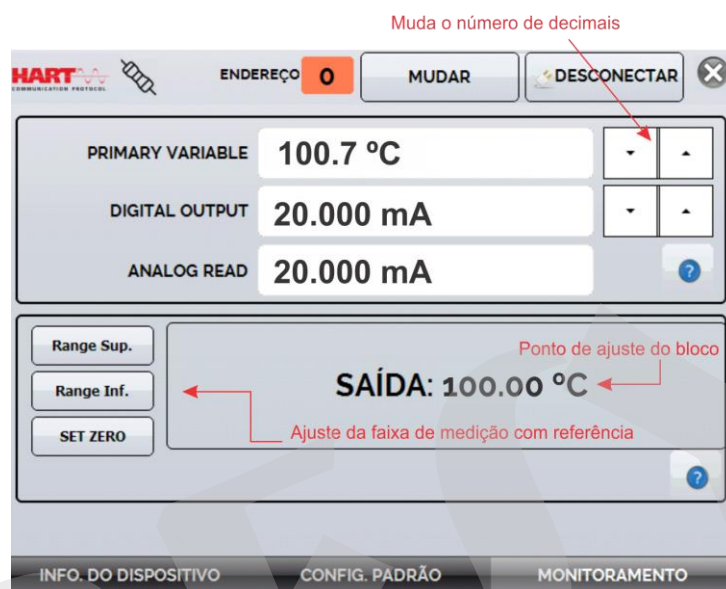
Fig. 23 - Ajuste da faixa de medição do transmissor HART® com referência
