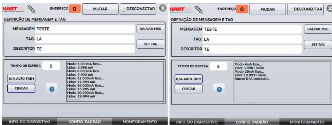
Fig. 24 - Verificação / Ajuste da saída mA do transmissor HART®
