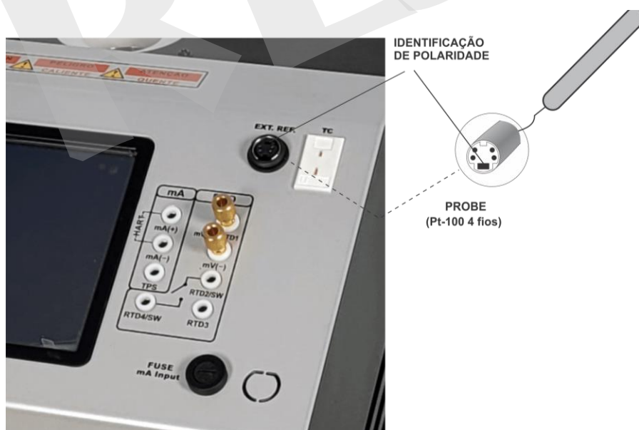
Fig. 10 - Conectando um Sensor Padrão para Referência Externa
