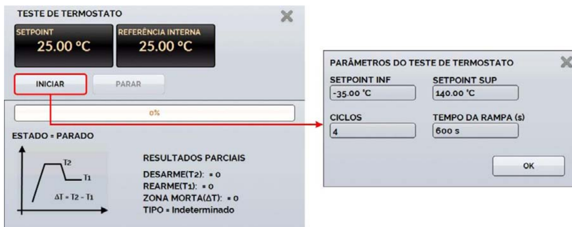
Fig. 14 - Parâmetros de teste automático de termostato
