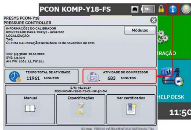
Fig. 117 - Manutenção Preventiva do Compressor
