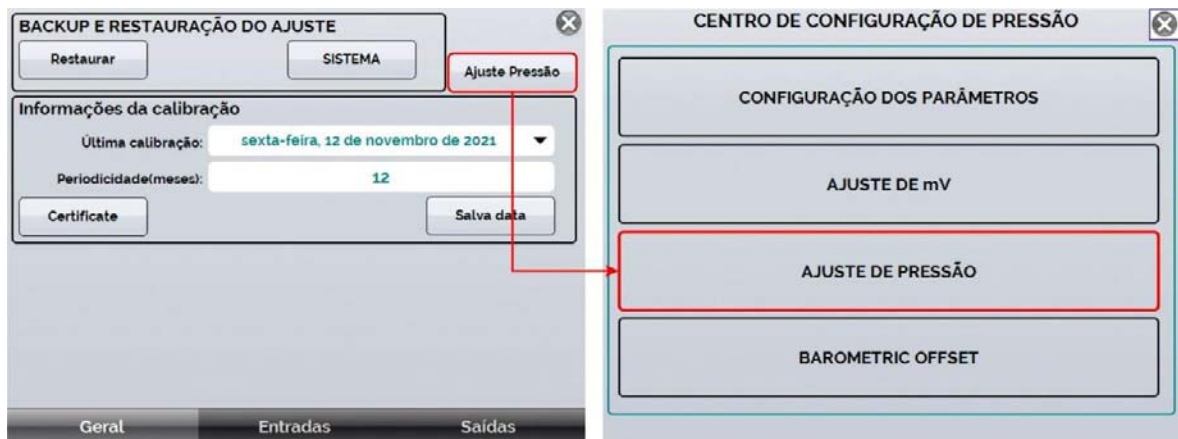
Fig. 106 - Acessando menu de ajuste de pressão
