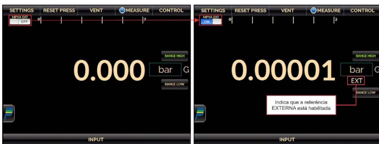
Fig. 56 - MPYA Conectado no modo MEASURE
