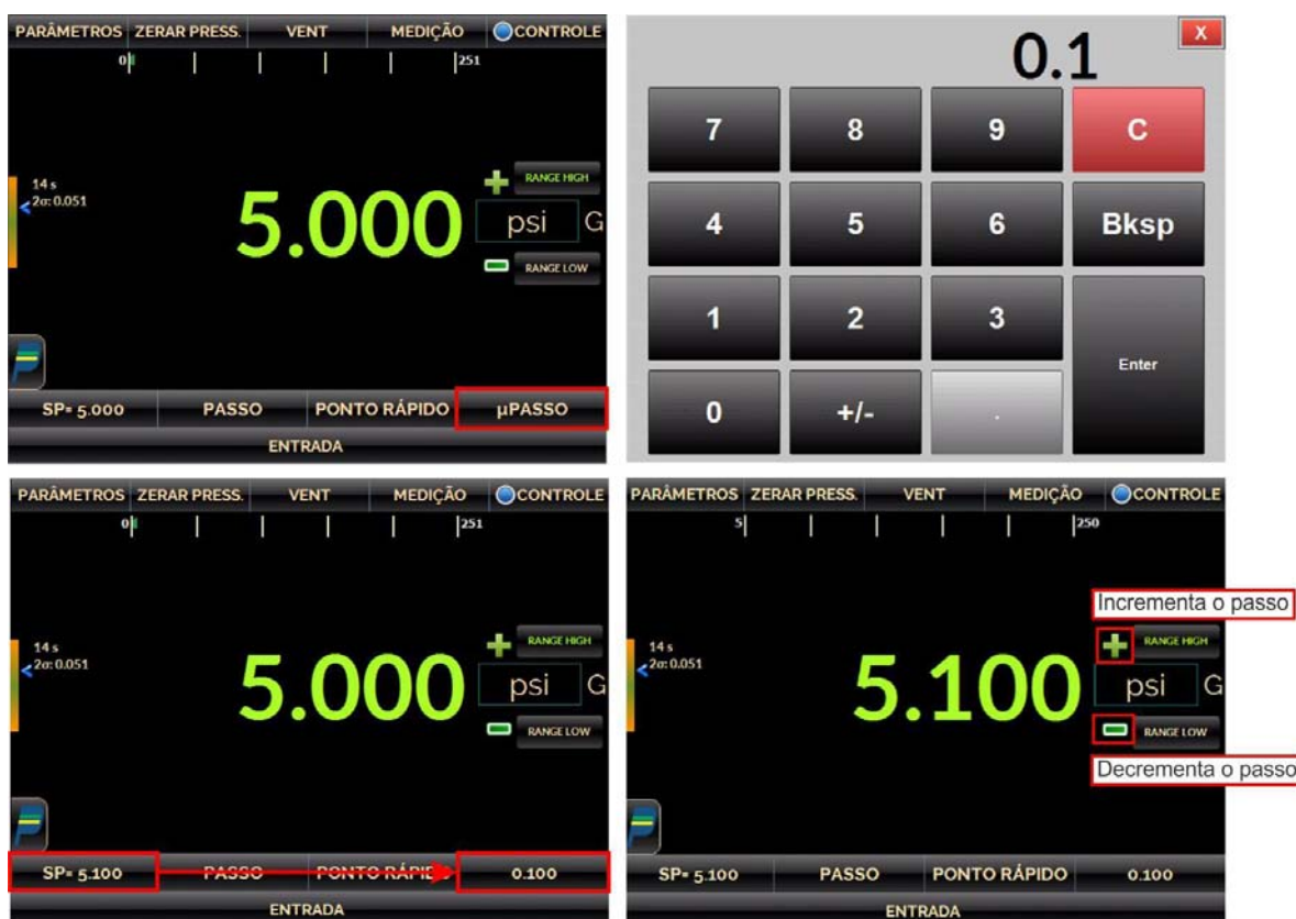
Fig. 31 - Função \mu Passo
