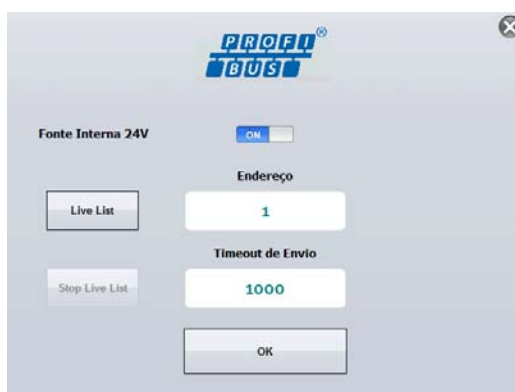
Fig. 76 - Tela de Configuração Profibus®
