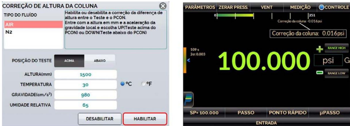
Fig. 26 - Menu da função correção de altura
