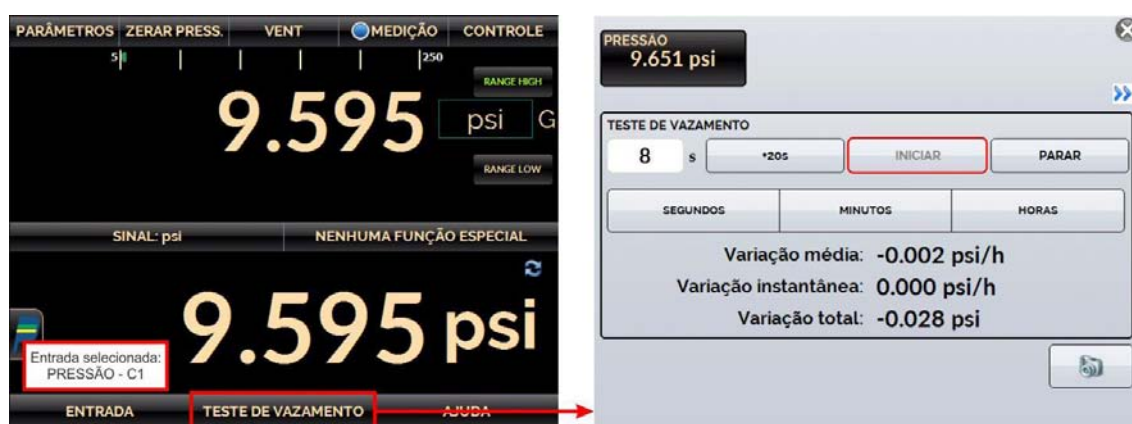
Fig. 51 - Teste de Vazamento
