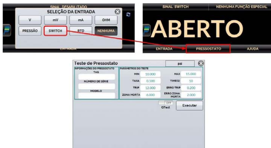
Fig. 49 - Teste de Pressostato
