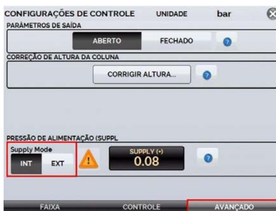
Fig. 07 - Alterando modo de alimentação de pressão
