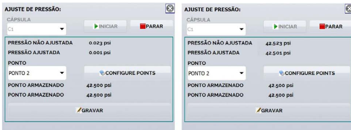
Fig. 111 - Armazenando pontos de pressão ajustada
