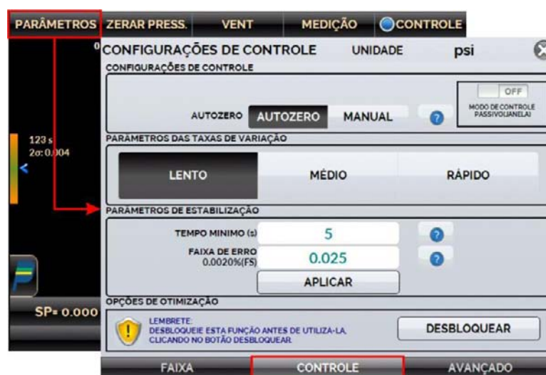
Fig. 20 - Configuração de Estabilização
