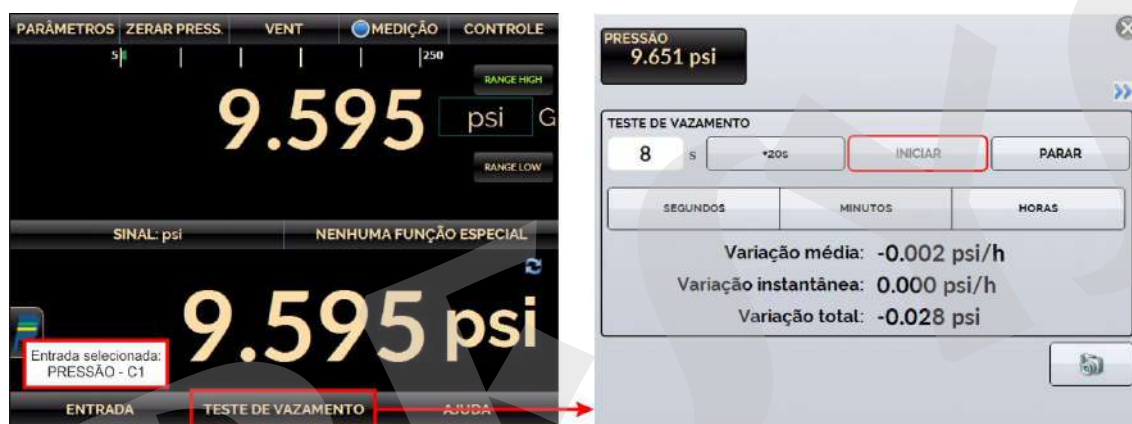
Fig. 51 - Teste de Vazamento
