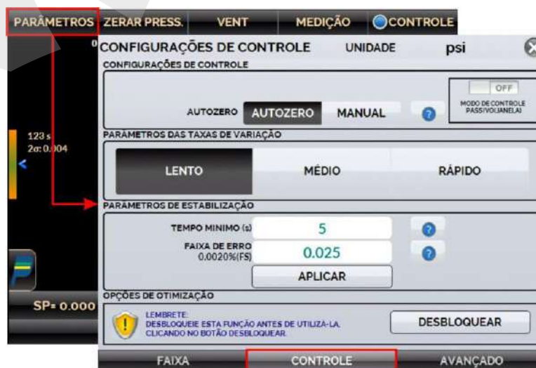
Fig. 20 - Configuração de Estabilização
