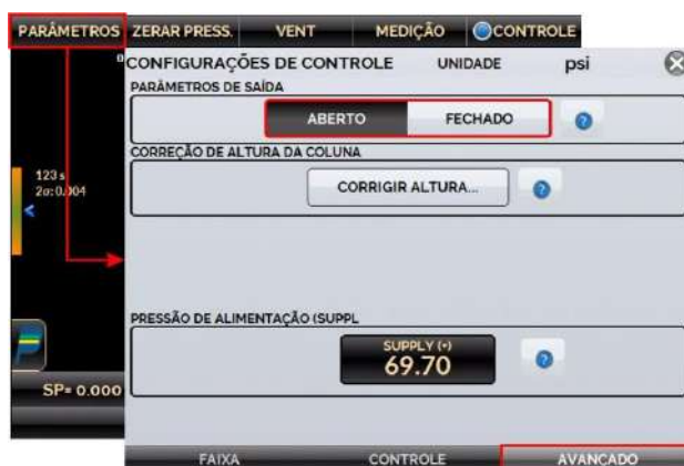
Fig. 19 - Estado da Válvula de Isolação de Saída
