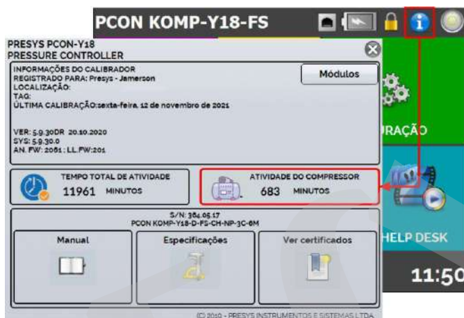
Fig. 117 - Manutenção Preventiva do Compressor
