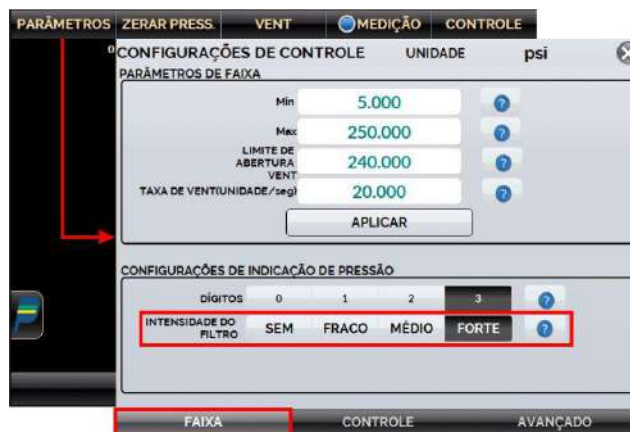
Fig. 39 - Intensidade do Filtro
