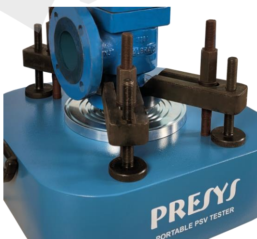
Fig. 29 - Válvula fixada à mesa.
