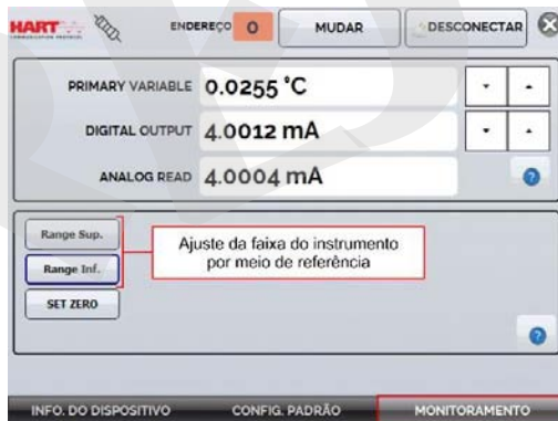
Fig. 14 - Ajuste da faixa de medição do transmissor HART ® com referência
