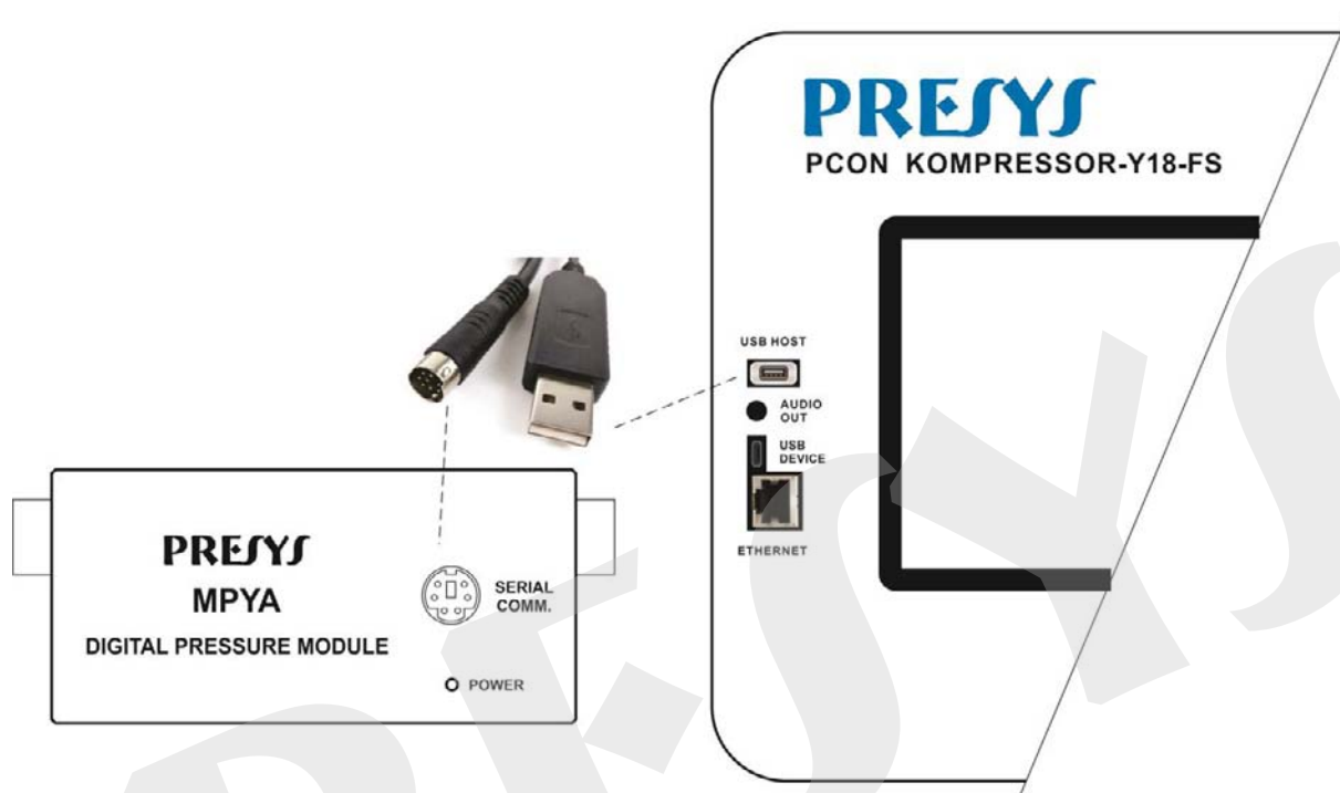
Fig. 03 - Conexão do Módulo de Pressão MPYA ao PCON
