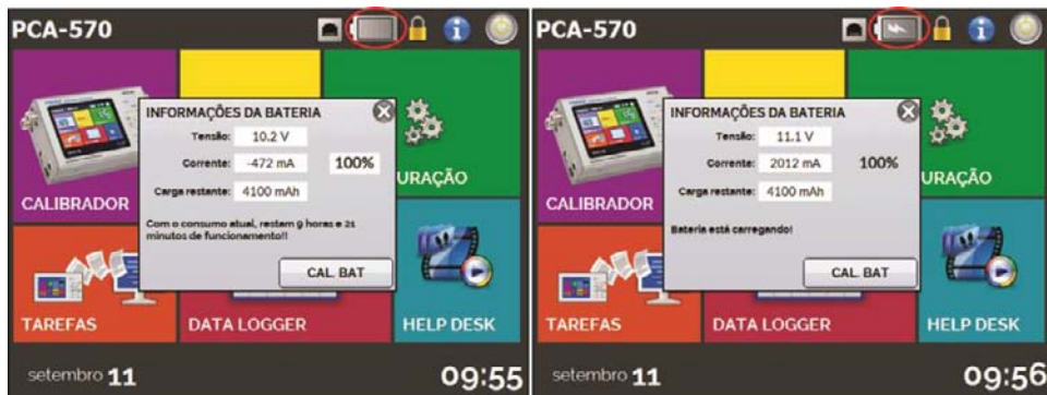
Fig. 08 - Status da Bateria
