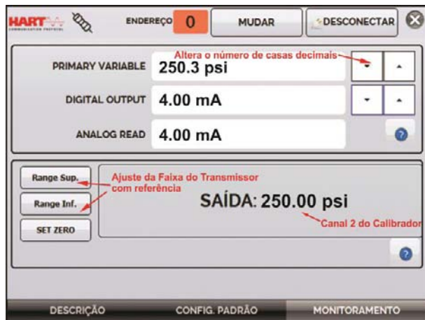
Fig. 37 - Ajuste da faixa de medição do transmissor HART® com referência
