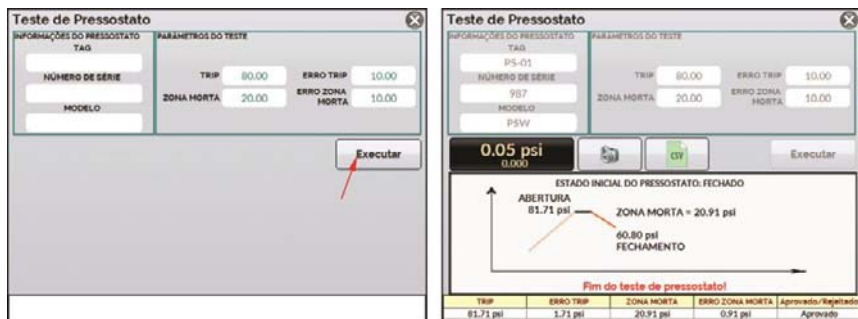
Fig. 14 - Teste de pressostato
