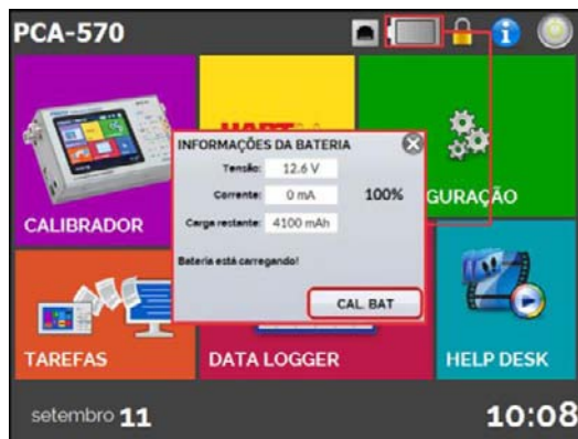
Fig. 57 - Verificando informações da bateria
