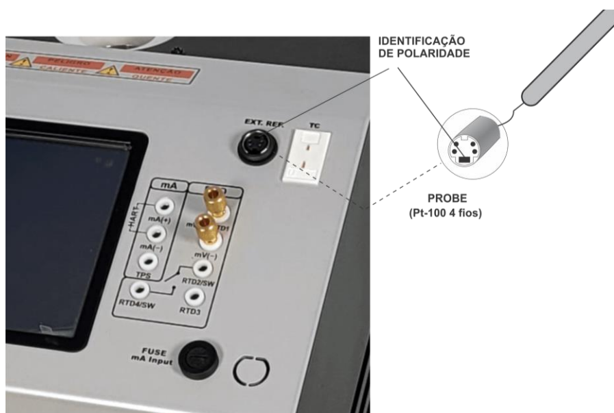
Fig. 10 - Conectando um Sensor Padrão para Referência Externa
