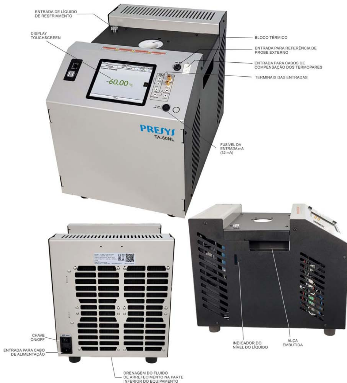
Fig. 01 - Identificação das Partes
