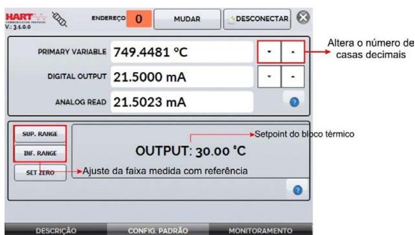
Fig. 24 - Ajuste da faixa de medição do transmissor HART® com Referência
