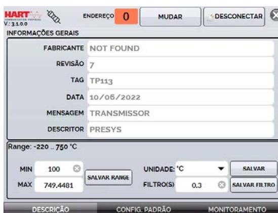
Fig. 22 - Ajuste da faixa de medição do transmissor HART®
