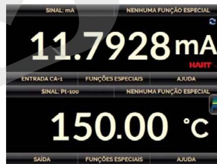
No campo IDENTIFICAÇÃO, digitar o Tag e clicar em CRIAR. O calibrador volta para a tela do CALIBRADOR. A tarefa está salva como Tag (TT300724), assim como o modelo (TT 0 a 300), para ser utilizado em outra calibração semelhante.
