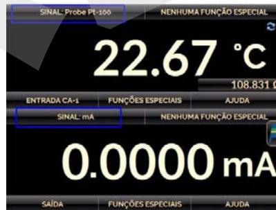
Configuramos entrada para temperatura e saída para mA.
