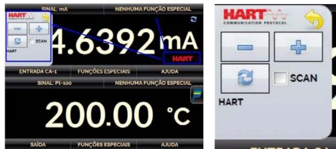
O ISOCAL MCS-XV também tem a possibilidade de um ajuste rápido do transmissor “Com Referência”, ou seja, sem utilizar os parâmetros internos do transmissor, mas se ajustando por uma referência externa, que no caso é a própria geração do ISOCAL MCS-XV. Para ajustar é só colocar o valor mínimo de entrada do transmissor e selecionar o sinal -. Depois simular o valor máximo e selecionar +. Em poucos segundos o transmissor é ajustado em zero e span. Para sair clica na seta amarela.
