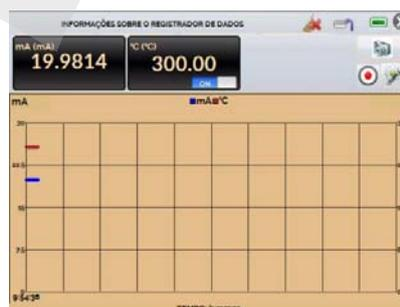
Na parte superior temos o ícone que reinicia a aquisição de dados. Os ícones minimizam o gráfico, retornando ao calibrador. A máquina fotográfica faz uma imagem jpg do gráfico. Os botões iniciam e param a gravação de dados.
