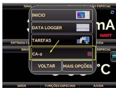
Neste menu podemos voltar a tela de INICIO, ir para um DATA LOGGER, acessar TAREFAS, configurar a saída como entrada. Vamos configurar para duas entradas.
