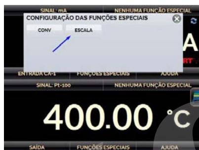
Nas CONFIGURAÇÕES DAS FUNÇÕES ESPECIAIS seleccionamos ESCALA.
