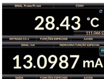
Um sinal de 28,43 °C de uma entrada de um Probe corresponde a 56,86 % de um range de 0 a 50 °C e que por sua vez corresponde a 13,098 mA de um range de 4 a 20 mA.
