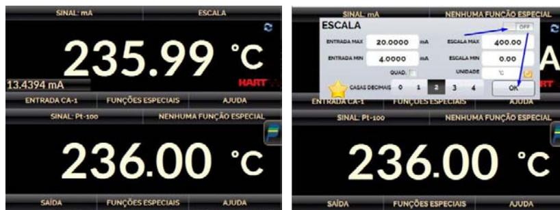
Desligamos a chave e a indicação de saída volta a mA.
