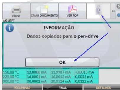
Se clicarmos em EXP. PEN-DRIVE, o certificado é transferido para um pen drive inserido no calibrador.
