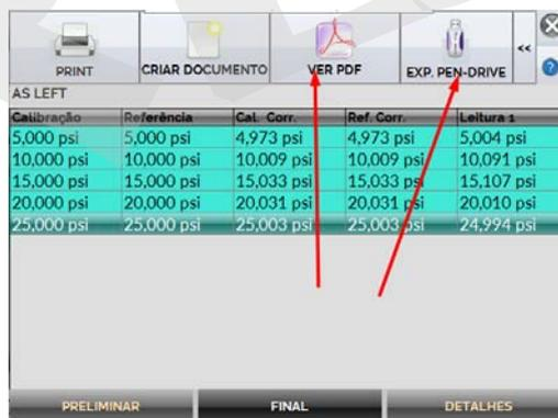
O certificado pode ser visto em PDF ou exportado para um pen drive colocado na porta USB do calibrador em formato .csv e .pdf.
