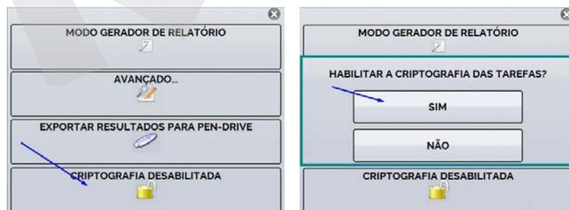
Se a CRIPTOGRAFIA for habilitada, os arquivos .xml internos do calibrador serão criptografados.
