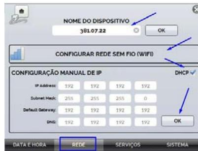
Em REDE podemos ver o número de série do dispositivo, configurar uma rede sem fio utilizando um dispositivo adaptador USB Wireless ou conectar através de cabo de rede.
