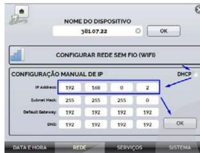
Na CONFIGURAÇÃO MANUAL DE IP podemos usar Dynamic Host Configuration Protocol (DHCP), para procurar a rede ou desabilitá-lo e inserir manualmente um endereço de IP.
