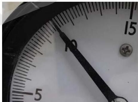
O primeiro ponto de calibração foi coletado. O novo ponto que deve ser inserido aparece no campo PONTO (10 psi). Continuar a inserir os valores solicitados e clicando em OK.
