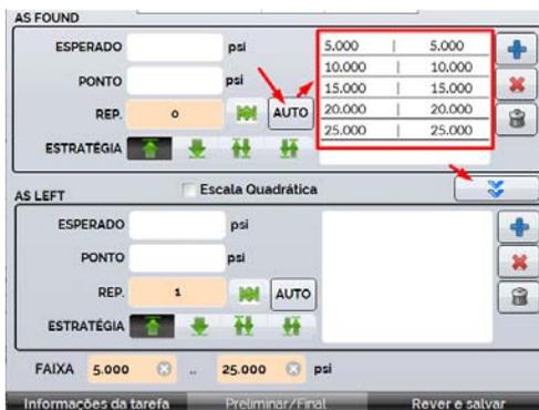
Em Preliminar/Final inserir os pontos de calibração.
