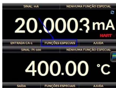
Neste exemplo temos um transmissor de temperatura de 0 a 400 °C com saída de 4 a 20 mA. Seleccionamos FUNÇÕES ESPECIAIS.
