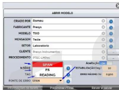
Em FONTE DE ERRO podemos escolher entre SPAN, FS (fundo de escala) ou READING (leitura).
