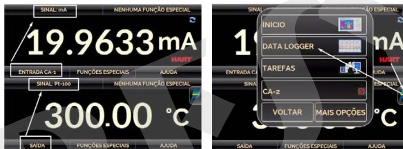
Na função CALIBRADOR configuramos um transmissor com entrada Pt-100 de 0 a 300 °C e saída 4 a 20 mA. Abrimos o menu no ícone “P” e selecionamos DATA LOGGER.
