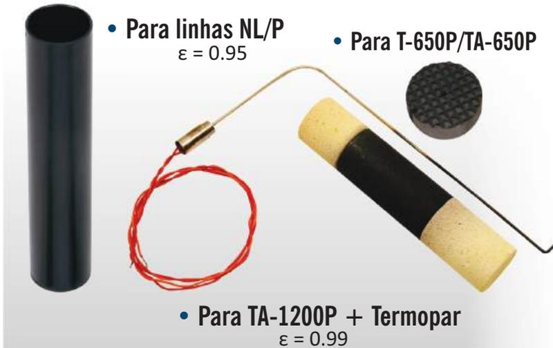
O insert de Corpo Negro transforma o banho térmico TA em um calibrador de termômetros infravermelhos.
