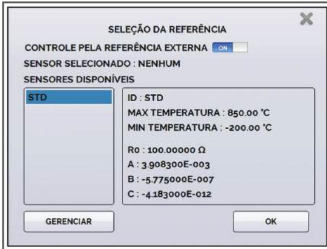
Os banhos térmicos TA são fornecidos com uma entrada para sensor de referência externo que pode ser usado para melhorar a exatidão, eliminando o desvio e o efeito de carregamento nos inserts sólidos ou para trabalhar com o insert específico de líquido agitado, insert de corpo negro ou insert sanitário.
