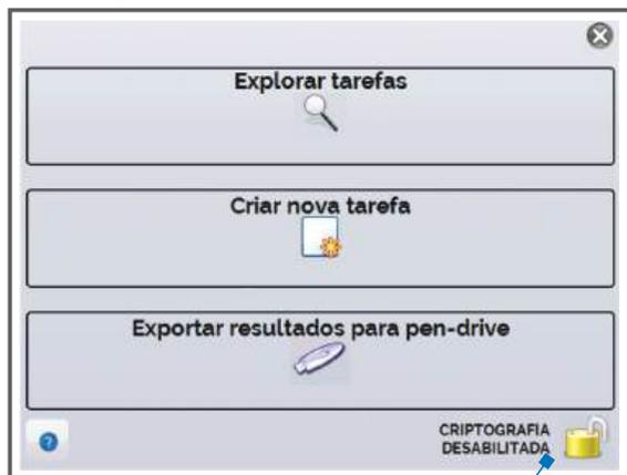
A comunicação com o software de calibração e também com o software ISOPLAN da Presys é criptografada para segurança da integridade dos dados de calibração em conformidade com o FDA 21 CFR Part 11. Quando ativado pelo administrador, o arquivo XML com os dados da calibração será criptografado.
