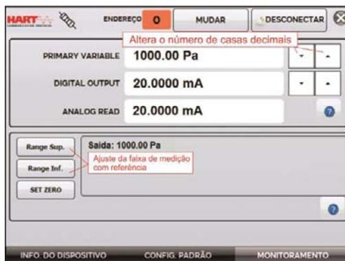
Fig. 57 - Ajuste da faixa de medição do transmissor HART® com referência
