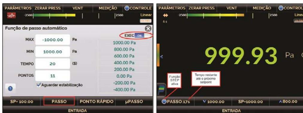
Fig. 23 - Função PASSO (Programa de STEP automático)
