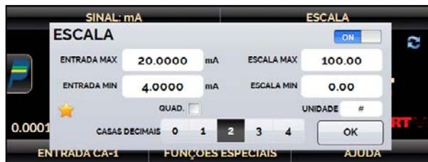
Fig. 40 - Função ESCALA (LINEAR)
