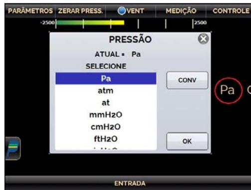
Fig. 31 - Unidade de Pressão/Temperatura
