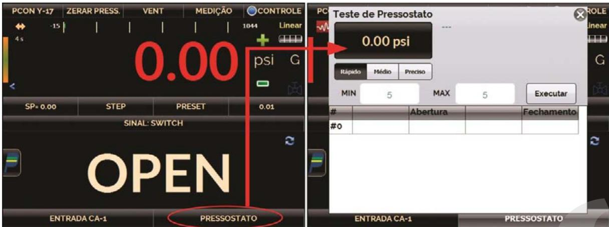
Fig. 45 - Teste de Pressostato
