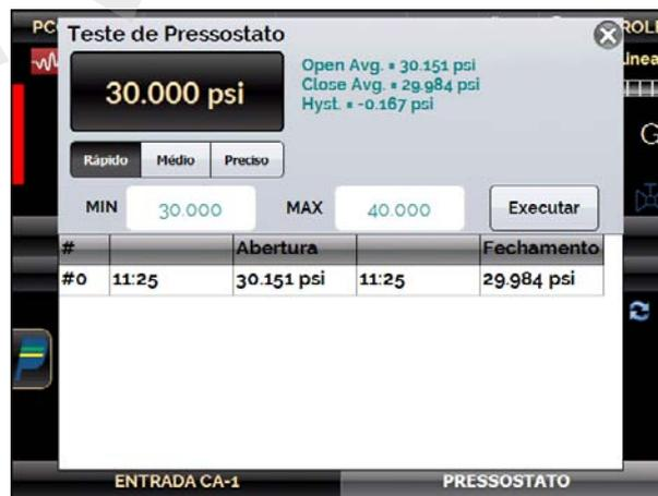
Fig. 46 - Resultados do Teste de Pressostato
