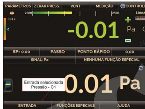
**Fig. 47** - Teste de Vazamento, Selecione o modo MEDIÇÃO e a ENTRADA
