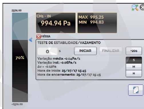
**Fig. 50** - Teste de Vazamento/Estabilidade - Resultados
