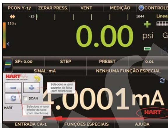
Fig. 56 - Quick HART® ajuste com referência
