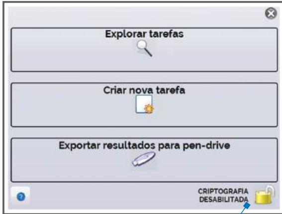
Pode-se criar tarefas usando a tela sensível ao toque ou conectando-se remotamente ao Calibrador PCON-Y18-LP pelo computador. Outros métodos também são possíveis como o envio de uma tarefa através de sua própria aplicação usando um arquivo XML ou através de uma aplicação do Excel™. O Calibrador PCON-Y18-LP também pode pegar a tarefa diretamente em um servidor remoto. Todas estas possibilidades estão descritas e documentadas no manual de comunicação.
