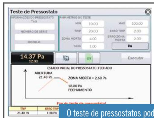
O teste de pressostatos pode ser executado automaticamente.
