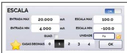
Os transmissores de pressão de 4-20 mA podem ser calibrados mostrando diretamente a pressão escalonada que será exibida em conjunto com a medida do valor atual.
