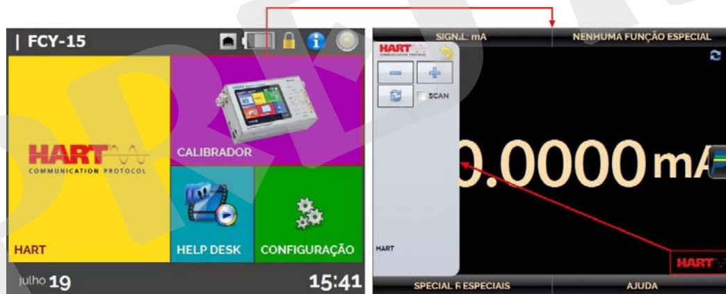
Fig. 13 - Ajuste rápido HART® com Referência
