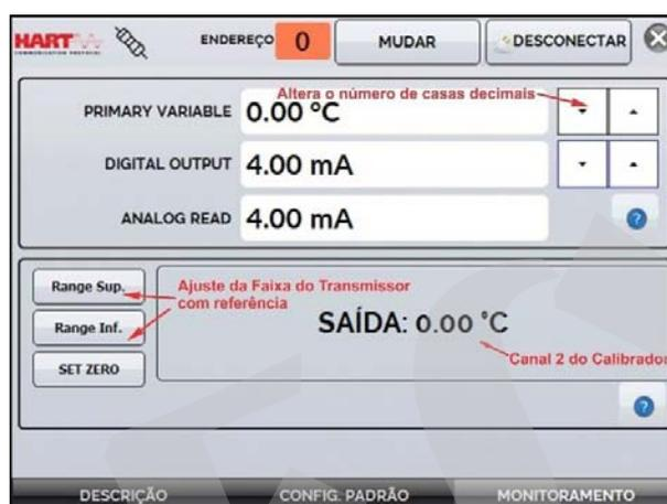
Fig. 24 - Ajuste da faixa de medição do transmissor HART® com referência
