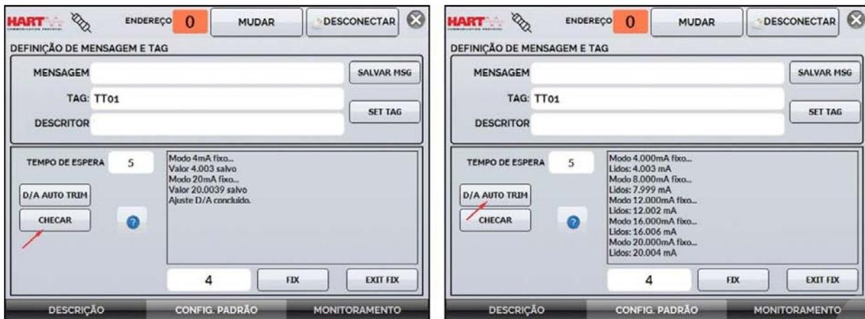
Fig. 25 - Verificação / Ajuste da saída mA do transmissor HART®
