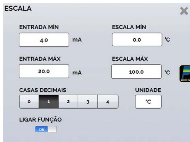
Fig. 19 - Configuração da Função ESCALA
