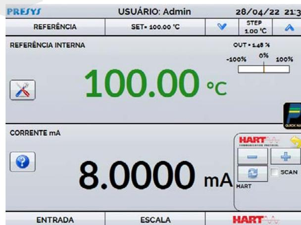
Fig. 23 - Ajuste Rápido HART® com referência
