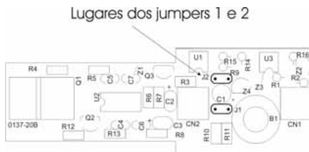
Fig. 24 - Localização dos jumpers na placa de saída analógica
