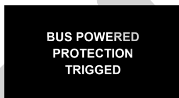
Figura 19 - Tela de disparo da proteção interna do comunicador
