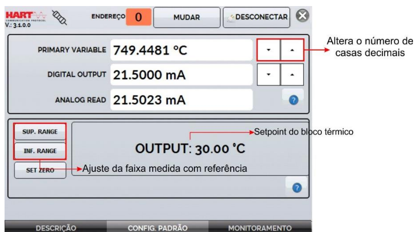
Fig. 24 - Ajuste da faixa de medição do transmissor HART® com referência
