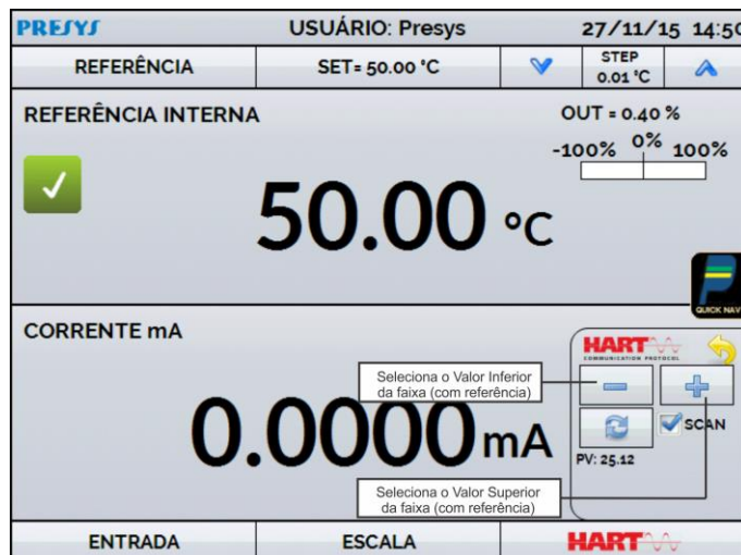
Fig 22 - Ajuste Rápido HART® com referência
