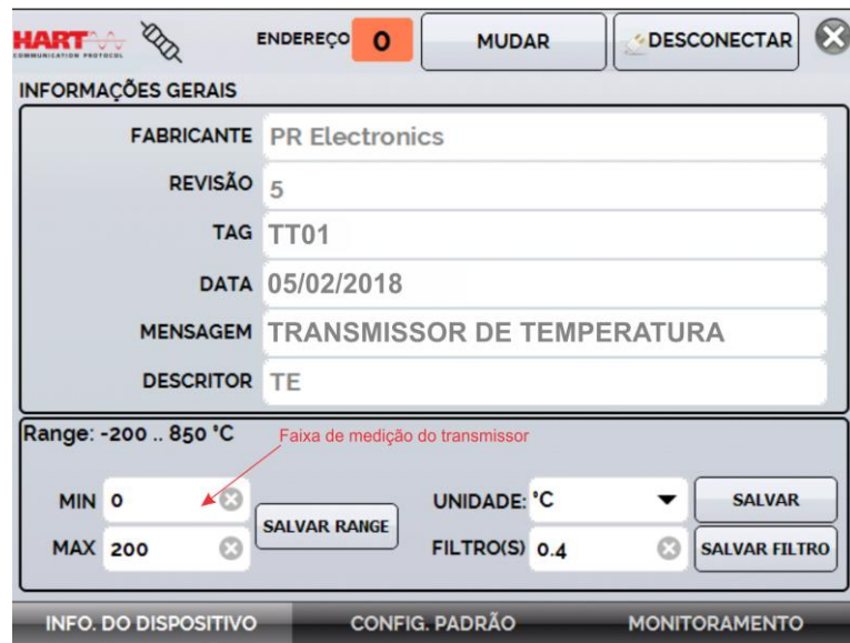
Fig. 21 - Ajuste da faixa de medição do transmissor HART®
