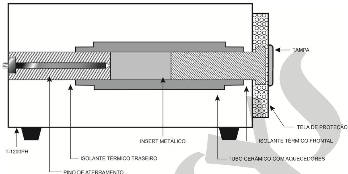
**VISTA ESQUEMÁTICA DA MONTAGEM DO INSERT**
