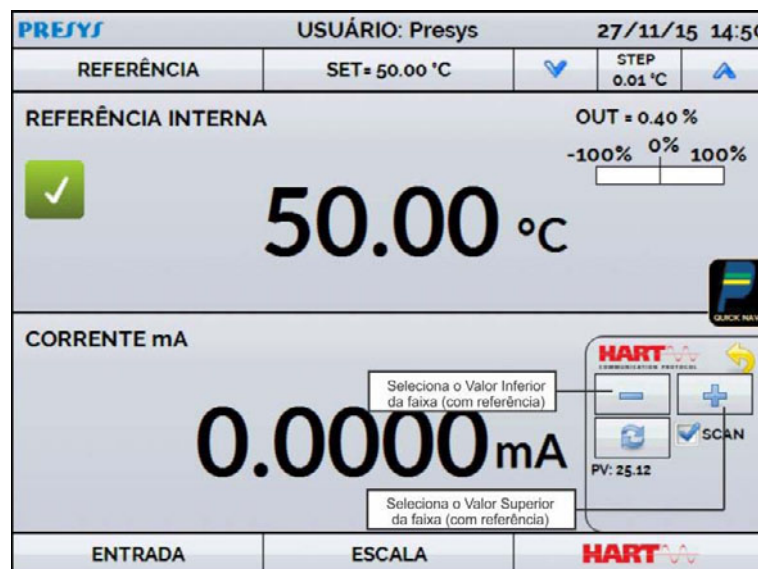
Fig 21 - Ajuste Rápido HART® com referência
