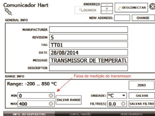
Fig. 20 - Ajuste da faixa de medição do transmissor HART®
