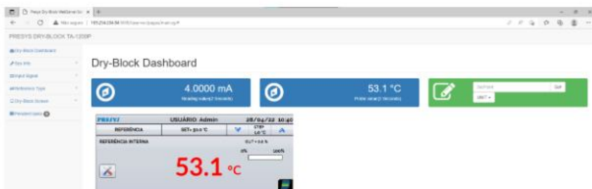
Fig. 36 - Servidor Web do Calibrador TA
