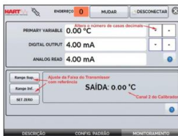
Fig. 24 - Ajuste da faixa de medição do transmissor HART ® com referência
