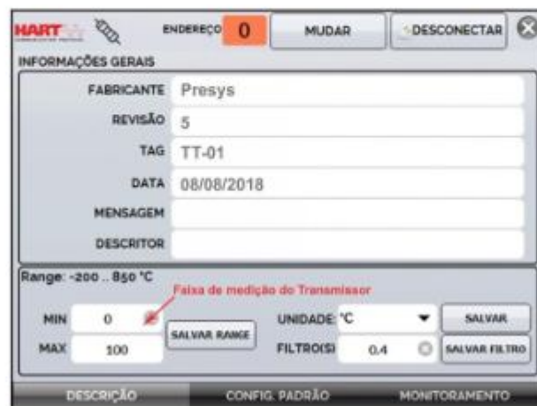
Fig. 22 - Ajuste da faixa de medição do transmissor HART®
