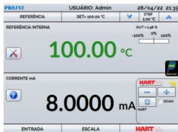
Fig. 23 - Ajuste Rápido HART® com referência
