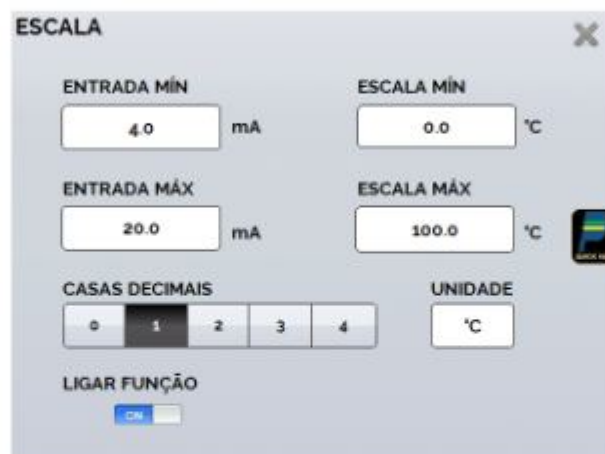
Fig. 19 - Configuração da Função ESCALA
