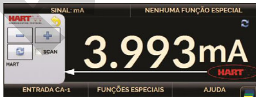
Fig. 49 - Ajuste rápido HART® com Referência
