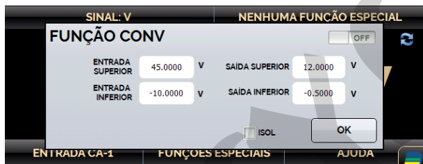
Fig. 29 - Configurações da Função CONV
