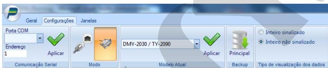
Na guia Modo, estão as duas opções: a primeira seleciona o modo **Modbus-TCP** e a segunda o modo **Modbus-RTU**; quando selecionado o modo **Modbus-RTU**, o usuário deve selecionar a porta COM (Serial RS-232) na qual o instrumento será conectado, e o endereço do instrumento.
