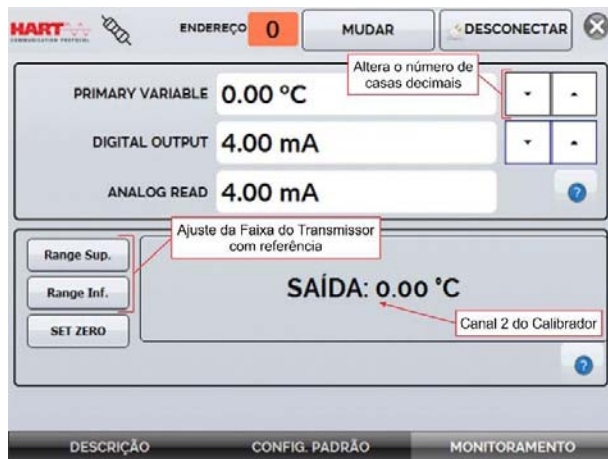
Fig. 46 - Ajuste da faixa de medição do transmissor HART ® com referência
