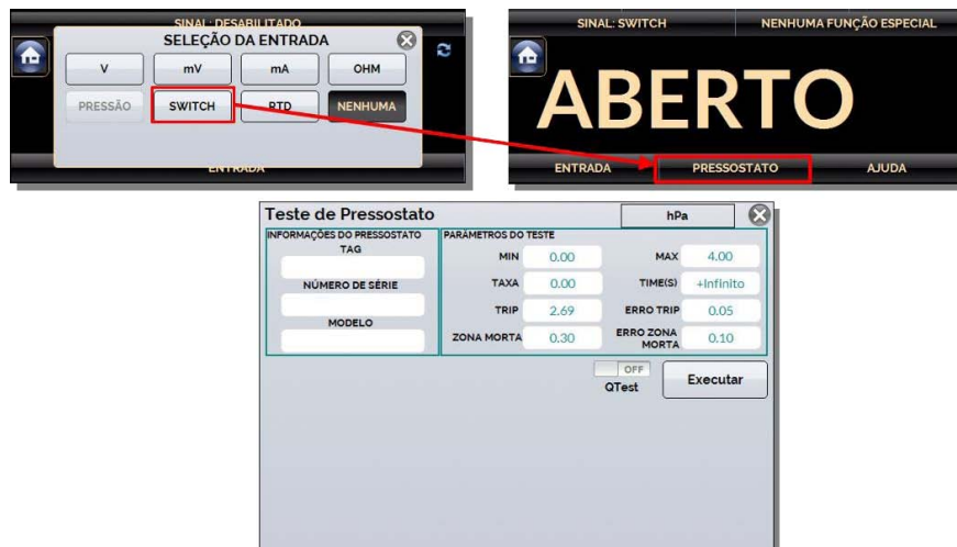
Fig. 41 - Teste de Pressostato
