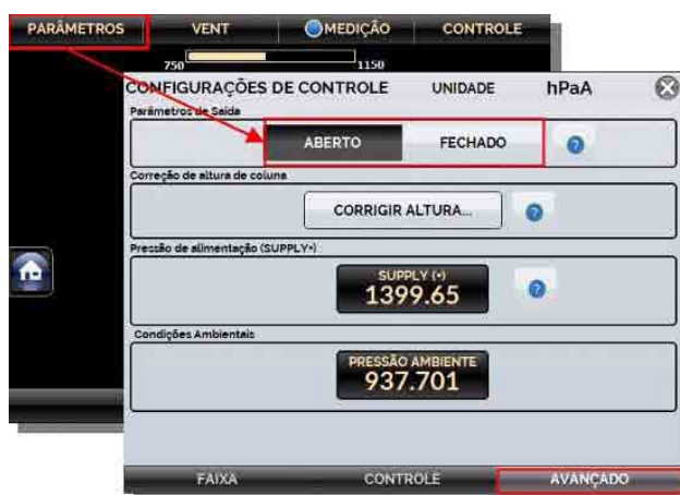
Fig. 14 - Estado da Válvula de Isolação de Saída
