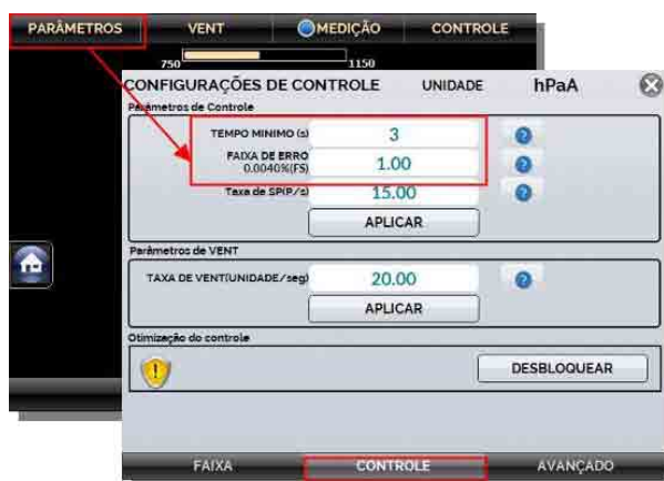
Fig. 15 - Configuração de Estabilização
