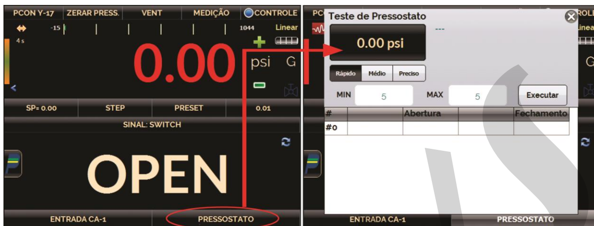
Fig. 48 - Teste de Pressostato
