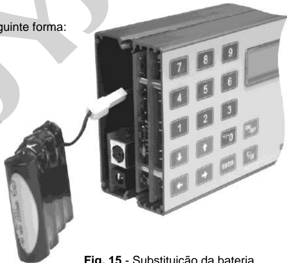
Fig. 15 - Substituição da bateria
