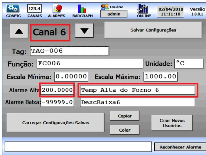
Agora se tivermos uma variação na temperatura do canal 6 que passe dos 200°C poderemos constatar na tela de alarmes online a existência de uma nova linha contendo o alarme, e na barra inferior do instrumento também teremos o último alarme que foi ativado.
