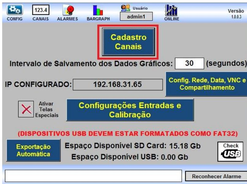
O instrumento possui 16 canais e podemos configurar o nome do Tag, Função, Unidade, Escala Mínima, Escala Máxima, Alarme de Alta, Alarme de Baixa, Descrição do Alarme de Alta e Descrição do Alarme de Baixa. Essas configurações servem para visualização e localização dos pontos nas demais telas, os alarmes desta parte não tem associação com os relés de saída do instrumento.
