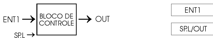
Fig. 23 - Representação do bloco de controle e do display no caso de setpoint local
