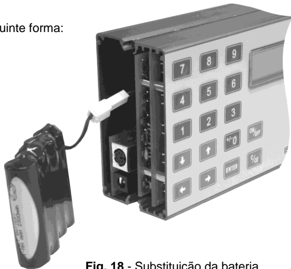
Fig. 18 - Substituição da bateria
