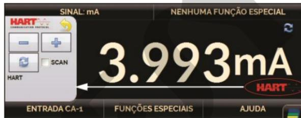
Fig. 36 - Ajuste rápido HART® com Referência
