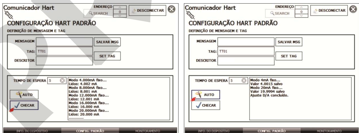
Fig. 58 - Verificação / Ajuste da saída mA do transmissor HART®
