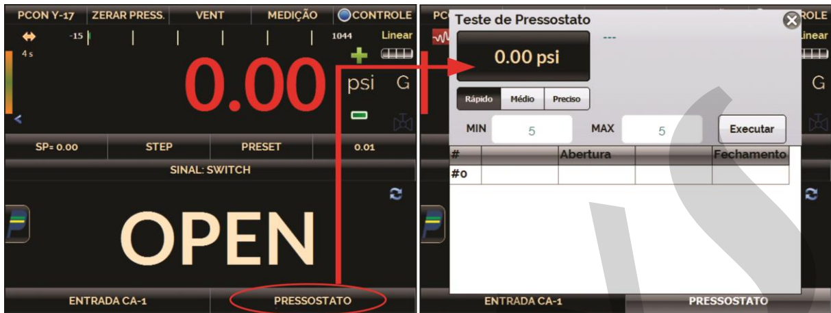
Fig. 45 - Teste de Pressostato
