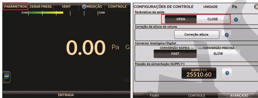
Fig. 11 - Estado da Válvula de Isolação de Saída
