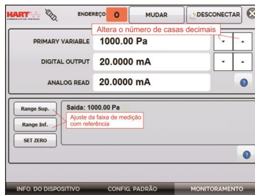
Fig. 57 - Ajuste da faixa de medição do transmissor HART® com referência
