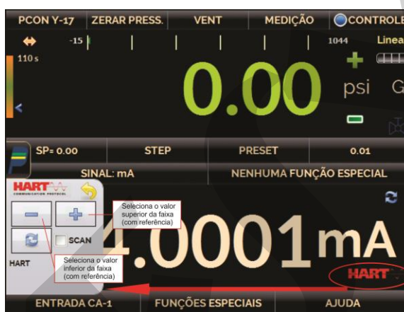
Fig. 56 - Quick HART® ajuste com referência
