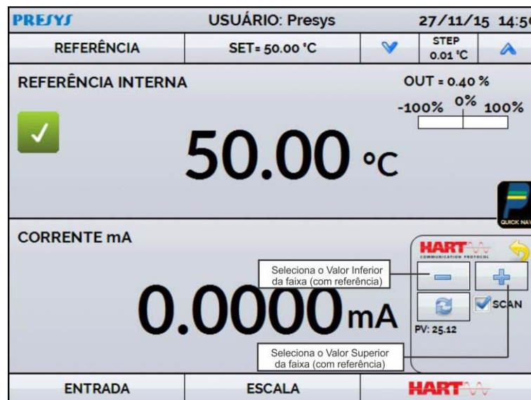
Fig 23 - Ajuste Rápido HART® com referência
