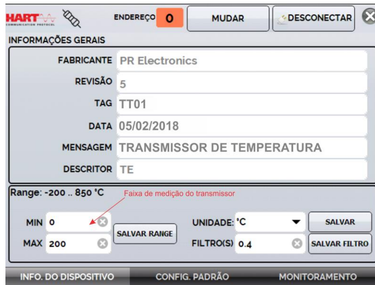
Fig. 21 - Ajuste da faixa de medição do transmissor HART®
