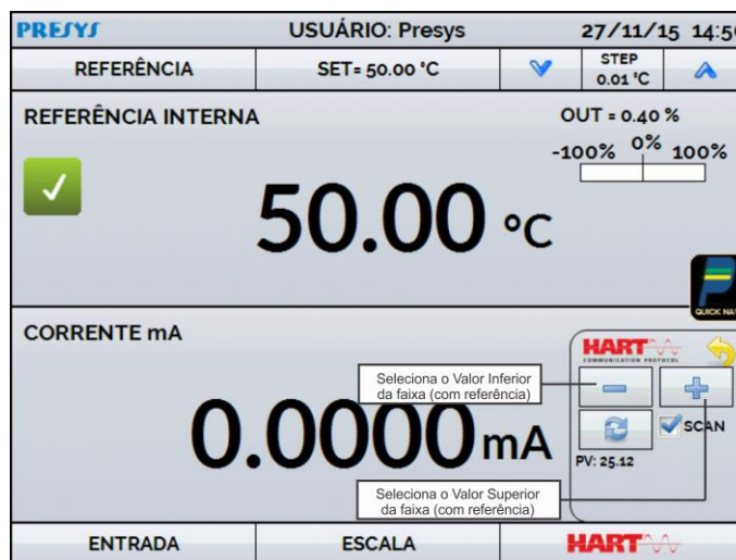
Fig 22 - Ajuste Rápido HART® com referência
