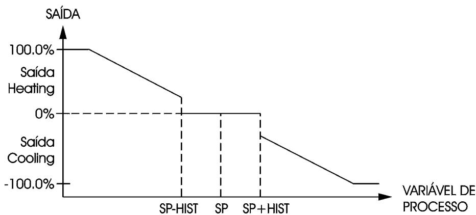
Para o controle Heating-Cooling Proporcional, a saída 1 será heating e a saída 2, cooling.
